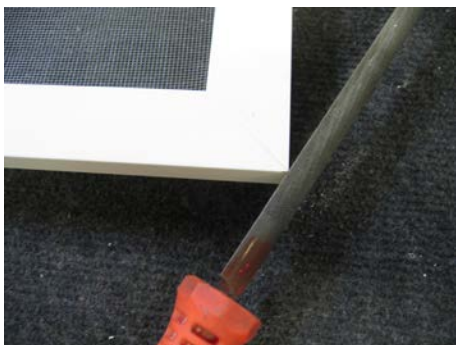
Zum Schluss sollten noch die scharfen Aussenkanten der Drehtür mit einer Feile entgradet werden.
